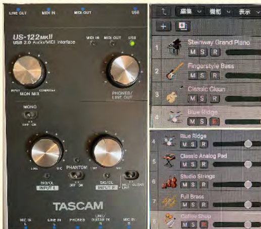
【左】 生音をパソコンに取り込む機器 【右上】 基本となるトラック ピアノ ベース ドラムなど 【右下】 ストリングスやブラスを加えたトラック
